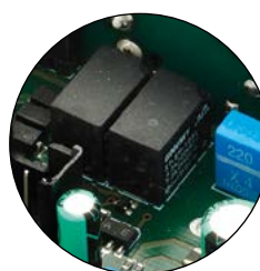
DOPPIO RELÈ CON CONTATTO DI SCAMBIO NA-NC
