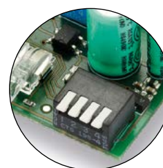
DIP SELEZIONE LIVELLO DI SENSIBILITÀ
