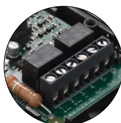
CONTATTO DI SCAMBIO NC-NA-C
